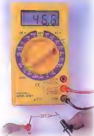
Figura 6.9. Prueba de las resistencias con el multímetro
